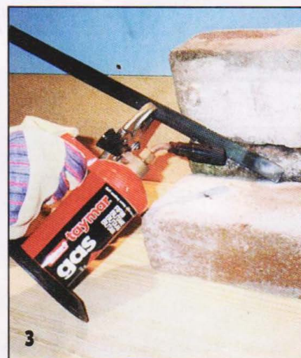
Перед гибкой сталь нагревайте до красного цвета. Работайте на негорючей поверхности, например, используя обычный кирпич.
