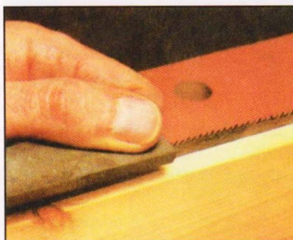
При фуговании зубьев пильное полотно следует закрепить так, чтобы оно выступало из зажимного устройства всего на несколько миллиметров.
