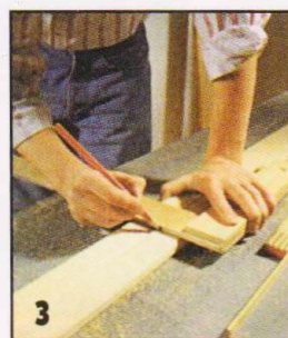
С помощью деревянного угольника и столярного карандаша размечают место крепления подножек.
