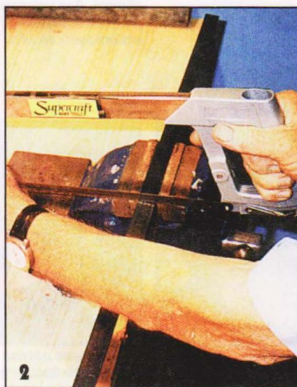
Отпилите заготовки по длине. Длину заготовки можно измерить шпагатом, уложив его по контуру детали на чертеже.
