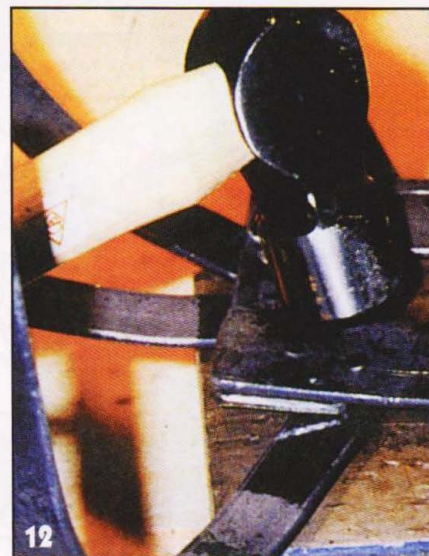
Приклепайте завитки к основанию. В качестве заклёпок можно использовать обрезки гвоздей.
