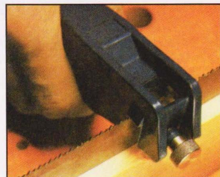
Ширину развода зубьев настраивают с помощью установочного винта разводки. Для проверки правильности развода совершают пробные резы.
