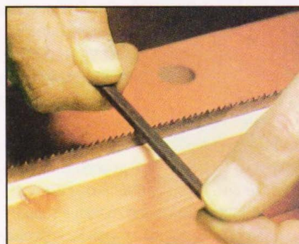
Для заточки пильное полотно прочно закрепляют. На какую глубину следует снять металл, точильщичку подсказывает его интуиция.
