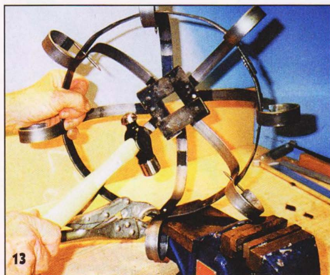
Последний этап сборки — клёпка завитков к обечайке.
