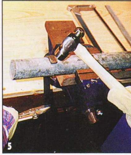
Окончательную форму придайте молотком. Чтобы не обжечься, всегда работайте в перчатках.
